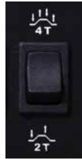
Izbor MIG zavarivanja u 2 takta i 4 takta.
