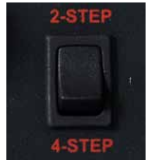
Izbor MIG zavarivanja u 2 takta i 4 takta
