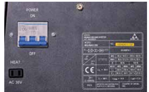
Trofazna sklopka na samom aparatu radi dodatne sigurnosti
